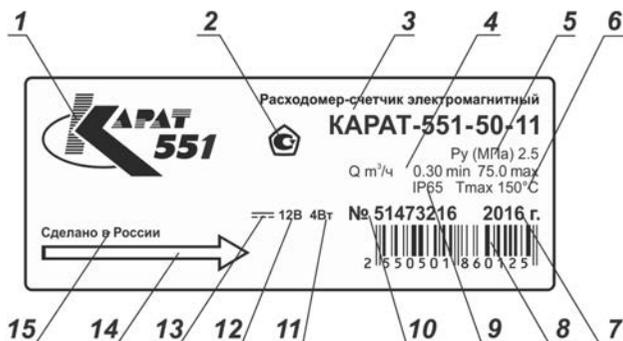
**Рисунок 1.8 – Маркировка на шильдике расходомера**
