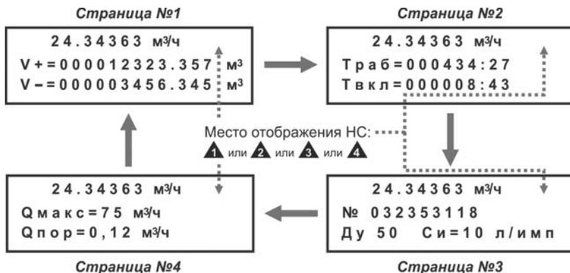
Рисунок 1.7 – Пример отображения индикации на ЖКИ прибора
