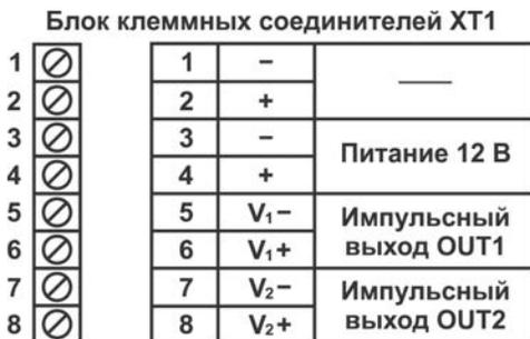
**Рисунок 1.6** – Схема подключения числоимпульсного выхода
