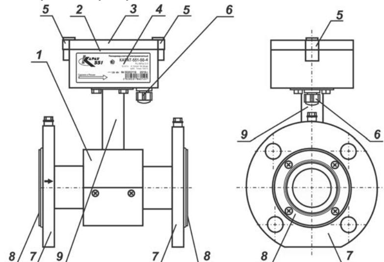
1 – проточная часть; 2 – электронный преобразователь; 3 – крышка корпуса электронного преобразователя; 4 – шильдик (маркировочная табличка); 5 – приливы для пломбирования; 6 – кабельный ввод; 7 – фланцы присоединительные; 8 – кольца защитные; 9 – стойка-соединитель
